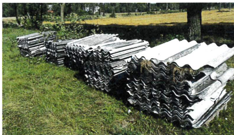
Rys. 2. Złożone płyty azbestowe - faliste (źródło: materiały własne)
