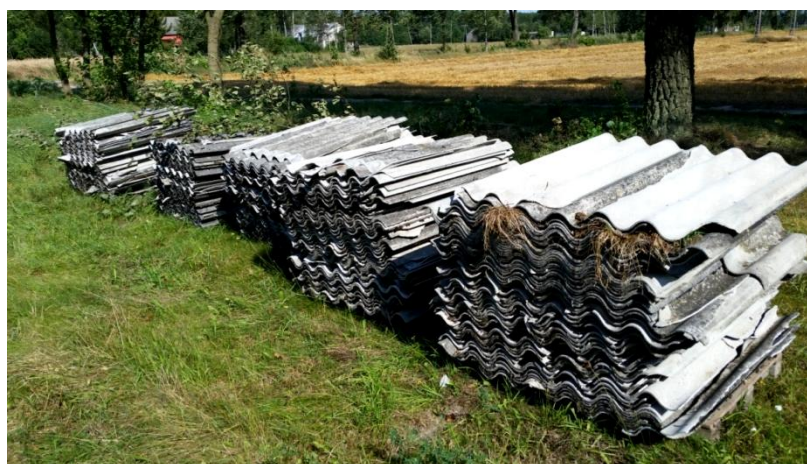
Rys. 2. Złożone płyty azbestowe - faliste (źródło: materiały własne)
