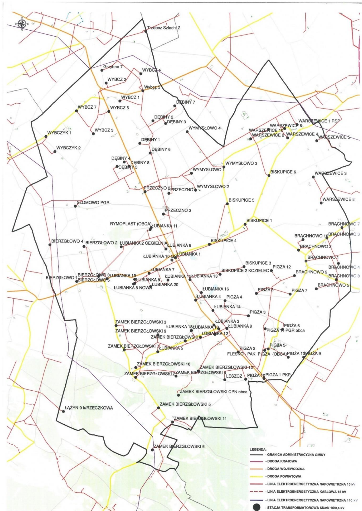
Rys. 7 Schemat sieci elektroenergetycznej na terenie gminy Łubianka: Źródło: ENERGA-OPERATOR SA
